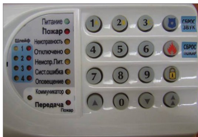
Рис. 3. Передняя панель приборов серии "Варта-1"
