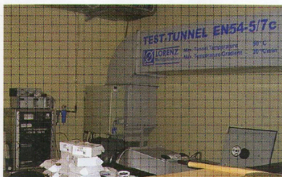
Дымовой и тепловой канал
