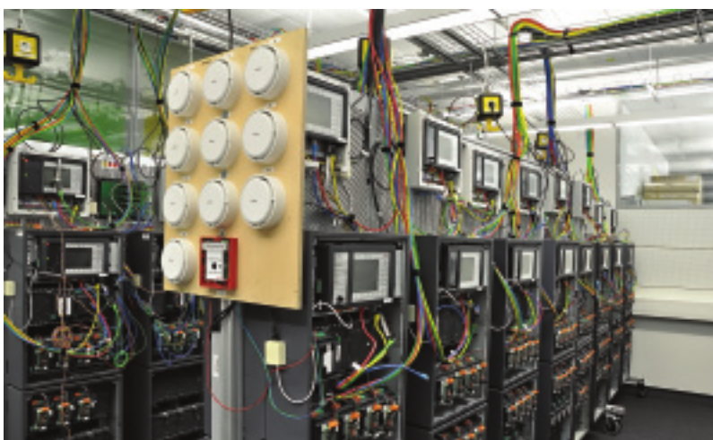
Лаборатория Bosch Security Systems, моделирующая работу крупномасштабной распределенной системы пожарной сигнализации
