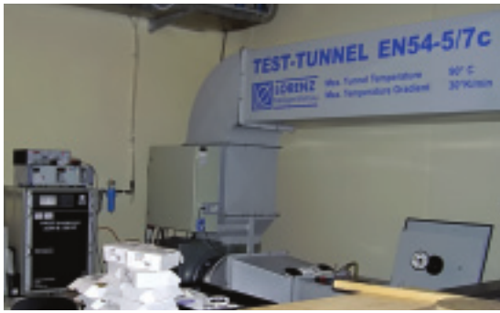
Дымовой и тепловой канал
