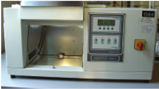
Камера искусственной светопогоды
