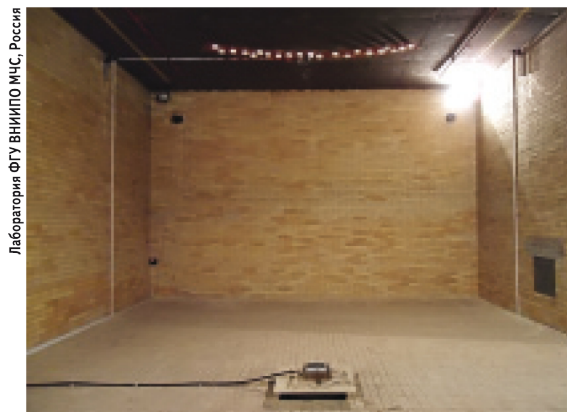
Помещение для проведения тестовых пожаров
