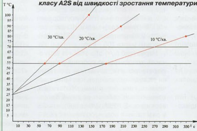
Рис. 3. Залежність температури спрацювання максимально-інерційних теплових сповіщувачів класу А2S від швидкості зростання температури
